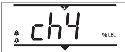
Figura 3.3 Ejemplo de sistema en estado de alarma
